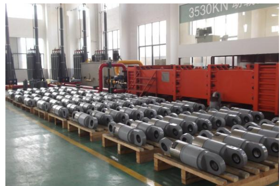
图7 常州容大 300t 动态测试台与出厂检验
