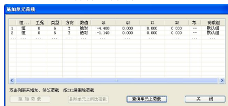
图 7 梁上施加单元荷载对话框
