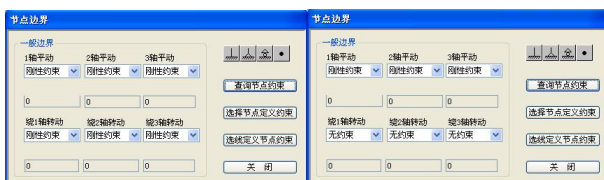
图 5 梁端支座节点边界对话框
