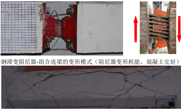
图4 组合连梁和传统连梁的性能对比
