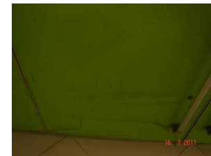
图 4 2006 年做的橱柜门聚酯漆(有机胶)的脆裂
