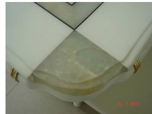
图 2 2006 年做的餐桌面有机树脂胶的老化开裂
