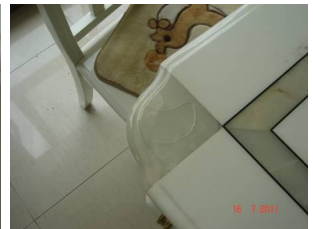
图 3 2006 年做的餐桌面有机树脂胶的脆裂
