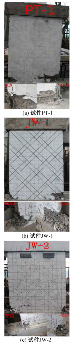
图 5 试验破坏现象
