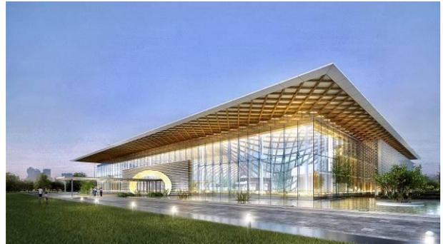
网安基地展示中心主体结构由单层自由曲面空间网格结构钢屋盖、主体框架结构、南北幕墙钢结构三部分组成。1)建筑形态自然、平滑,采用流线形的钢管编织成单层网壳结构。2)结构就是建筑形态本身,空间、结构、表皮一体化,建筑网格通透、灵动、自由。3)依靠数字技术,利用最小应变能原理对结构形态进行优化,得到力学效能最大、材料最省的结构,创造出精致的外表、紧凑的韵律,并且由产生了丰富的艺术效果。
