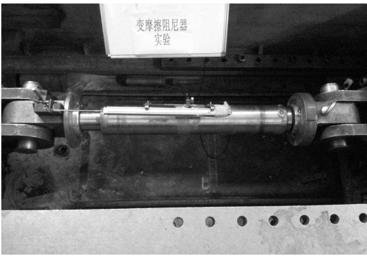
图 3 新型变摩擦阻尼器试验现场
